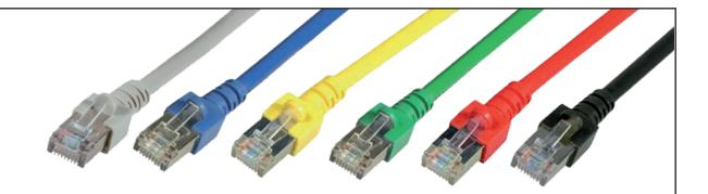
1 Gigabit Ethernet Cat.5e 100 MHz Patchkabel. 2 x RJ45 Stecker geschirmt, IEC 60603-7-3. SF/UTP 4 x 2 x AWG26/7 PVC Ø=5.7 mm, Folien- und Geflechtschirm. Belegung nach TIA/EIA 568B, flammwidrig IEC 60332-1. Umspritzte Knickschutztülle mit Klinkenschutz.
