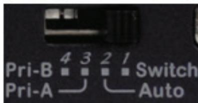
1 Switch: Anwahl der Eingangsquelle über Eingangswahltaster, Fernbedienung oder über externe Steuerung (serielle Steuerung). Die Kontroll-LED der ausgewählten Quelle leuchtet.
